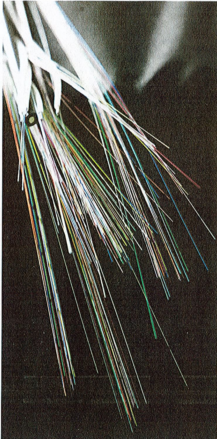
Teure Infrastruktur der Zukunft: Glasfaserkabel lösen Kupferkabel ab.
