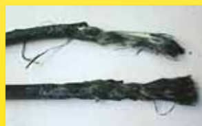
Brände durch Blitz Kurzschlüsse von nebenliegendem Hochspannungskabel
